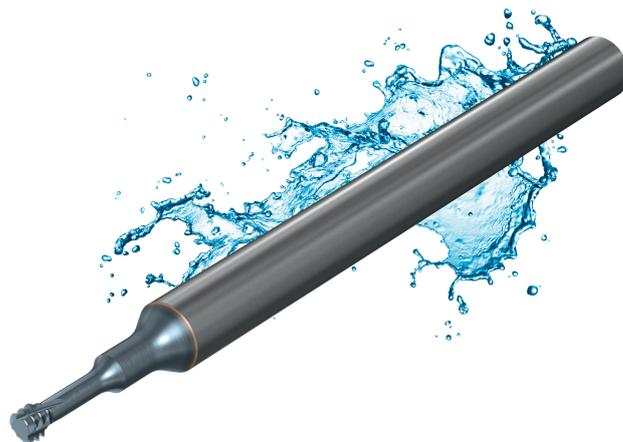
**3** Bei den TiCN-beschichteten VHM-Miniatur-Gewindefräsern Millipro Dental zum Gewindefertigen von Zahnimplantaten verhindert ein verstärkter Schaft, dass die Werkzeuge bei schwierigen Bedingungen und bei kurzzeitiger Überlastung brechen (© Vargus)
