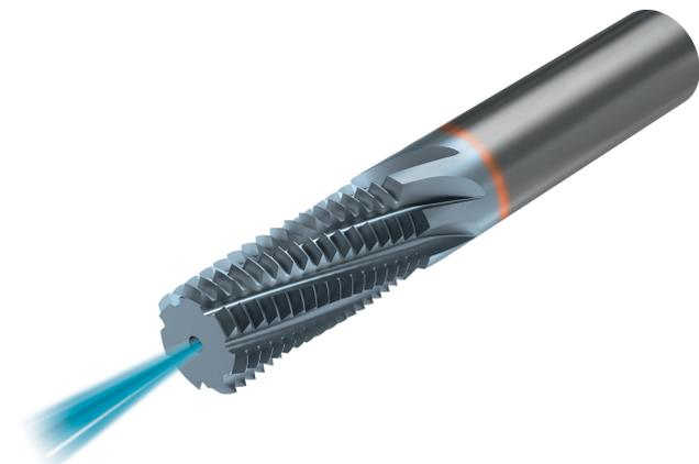
**2** Bis zu 60 Prozent schneller als übliche Werkzeuge fertigt der VHM-Gewindefräser TM-Solid Multi-Flute ein Gewinde. Sein Vorteil: vier bis sieben spiralisierte Spannuten und eine innere Kühlmittelzufuhr mit radialem Fluidaustritt (© Vargus)
